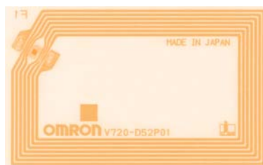
Figuur 1. Een RFID-tag. De stip linksboven is de chip, de koperen banen vormen de antenne.
